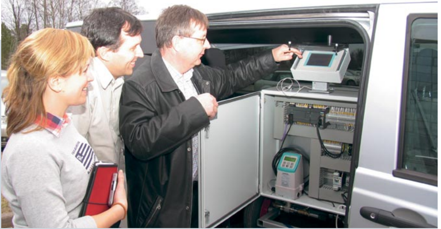
Tage Strandberg förklarar hur ALT-maskinen – Automatic Leakage Tester – fungerar. Enkel att hantera, enkel att administrera. Susanne Cederberg och Jos Klein Woud från Siemens lyssnar och lär.
